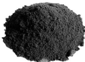
ZES 社独自技術により量産化に 成功した二酸化バナジウム
